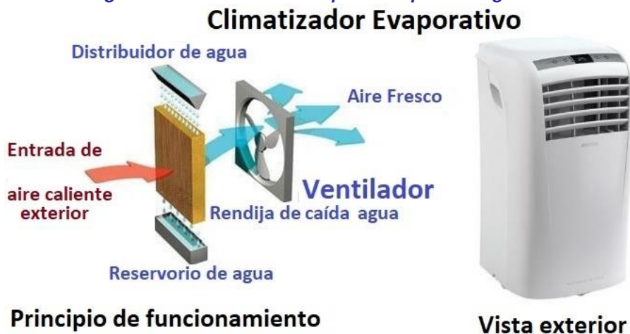
Figura 16. Climatizador evaporativo para refrigeración
