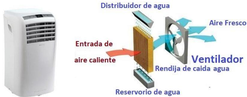
**NOTAS:** A la izquierda se ilustra su funcionamiento, por una rejilla húmeda, se fuerza con el ventilador una corriente de aire caliente de medio. El agua de la rejilla se evapora absorbiendo calor, por lo que el aire se enfría y es impulsado al exterior. Así se genera un flujo de aire algunos grados más fríos que el entrante. Muy adecuado para climas secos, pero aun en el AMBA funcionan adecuadamente.
