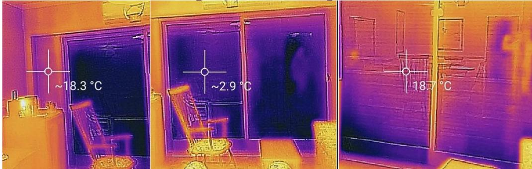
**NOTAS:** izquierda medición de la temperatura de la pared (18,3°C), medio temperatura de la superficie del vidrio (2,9°C) y derecha temperatura del vidrio una vez que se cierra la persiana de madera (18,7°C).
