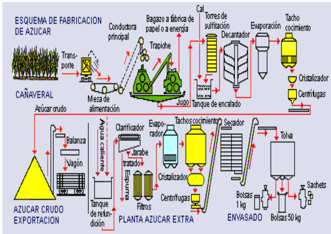
Gráfico 5. Esquema del proceso de elaboración del azúcar
